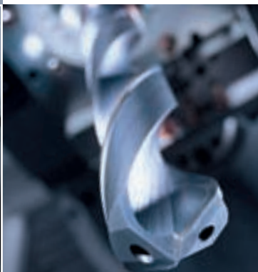
Oben: Option innere Kühlmittelzuführung.
