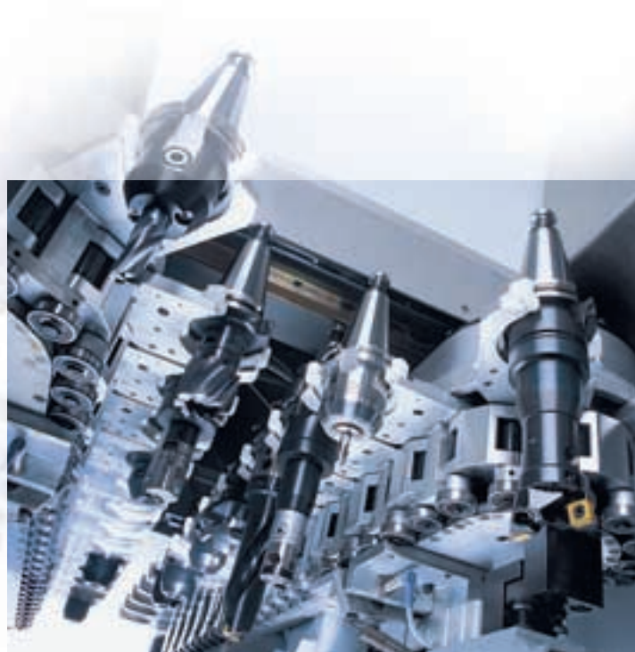
Oben: Schneller Werkzeugwechsel mit Pick-up.
