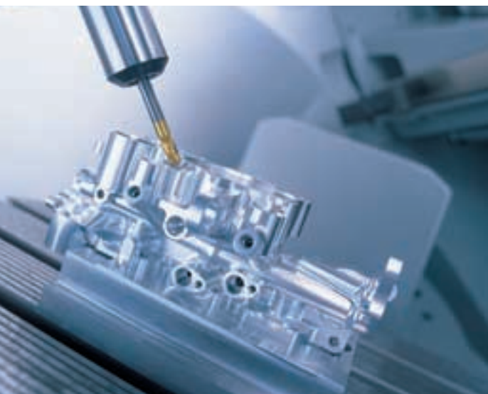
Effizient: 5-Seiten- bis hin zur 5-Achs-Simultanbearbeitung.
