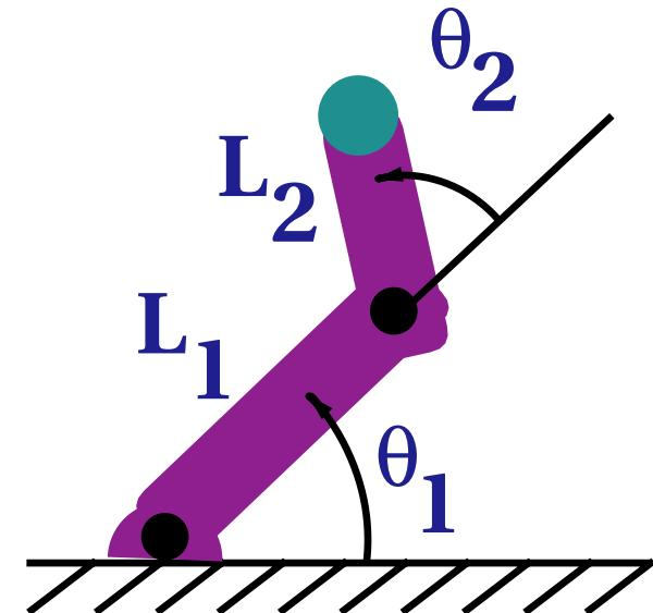
$$\begin{bmatrix} & & & \\ & & & \\ & & & \\ & & & \end{bmatrix} = \begin{bmatrix} \text{rot } \theta_1 \\ & & & \\ & & & \\ & & & \end{bmatrix} \begin{bmatrix} \text{trans } L_1 \\ & & & \\ & & & \\ & & & \end{bmatrix} \begin{bmatrix} \text{rot } \theta_2 \\ & & & \\ & & & \\ & & & \end{bmatrix} \begin{bmatrix} \text{trans } L_2 \\ & & & \\ & & & \\ & & & \end{bmatrix}$$
