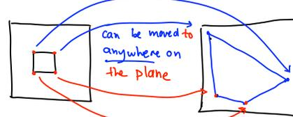
$$\begin{bmatrix} u_k \\ v_k \\ 1 \end{bmatrix} \approx \begin{bmatrix} a & b & c \\ d & e & f \\ h & i & j \end{bmatrix} \begin{bmatrix} x_k \\ y_k \\ 1 \end{bmatrix}$$
