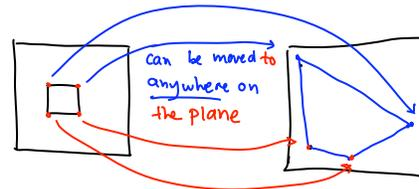
$$\begin{bmatrix} u \\ v \\ 1 \end{bmatrix} \approx \begin{bmatrix} a & b & c \\ d & e & f \\ h & i & j \end{bmatrix} \begin{bmatrix} x \\ y \\ 1 \end{bmatrix}$$
