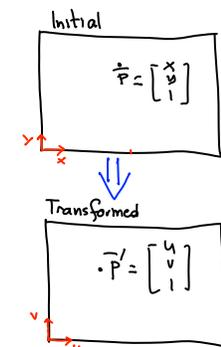
$$\begin{bmatrix} x \\ y \end{bmatrix} \xrightarrow{H} \begin{bmatrix} u \\ v \end{bmatrix} = A \begin{bmatrix} x \\ y \end{bmatrix} + \bar{t}$$
