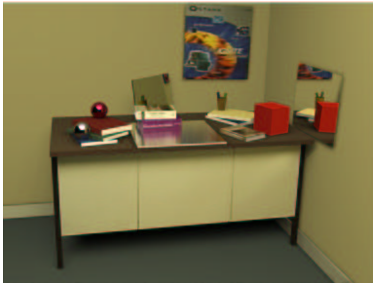
FIG. 4.10 – Exemple d'image de résolution 768 \times 576 calculée par Phoenix, en 36 minutes (dont 23 de lancer de rayons en seconde passe). Cette scène comporte 155000 facettes et 10 rayons sont lancés par pixel. Lorsque la surface est glossy , 100 rayons sont ici relancés pour l'intégration de l'angle solide, soit 1000 rayons pour chaque pixel recouvert par la plaque d'aluminium au centre de l'image.
