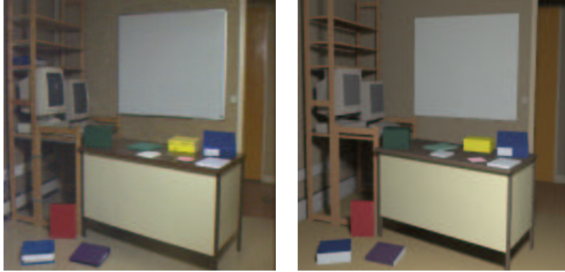
FIG. 6.11 – Exemple d'une reconstruction d'une image réelle (à gauche) par une approximation diffuse de toutes les surfaces (à droite)
