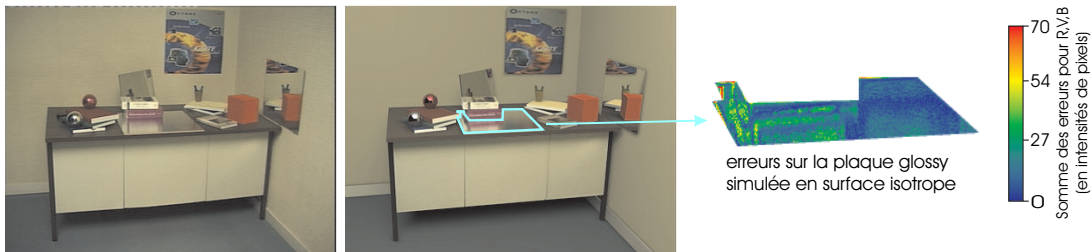
FIG. 6.21 – Approximation de la plaque d'aluminium anisotrope de l'image réelle (à gauche), par une surface isotrope dans l'image de synthèse (au centre). L'erreur entre ces deux images, pour la plaque d'aluminium est visible sur l'image de droite. On constate que cette erreur est grande sur les zones où la réflexion est censée "s'étaler". Les pixels rouges correspondent à une erreur très élevée, mais ne sont pas significatifs, car ils proviennent des bords de l'objet, et sont causés par le calage relativement approximatif du modèle 3D.
