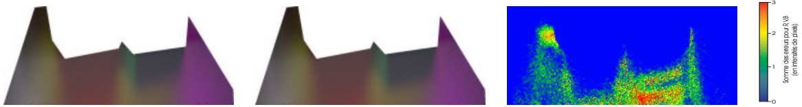
FIG. D.3 – À gauche : sol anisotrope de l'image d'origine. Au centre : sol simulé de façon isotrope dans l'image synthétique. À droite : Image des erreurs issue de la différence entre l'image originale et l'image régénérée.
