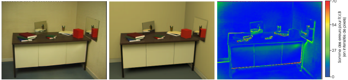
FIG. 6.18 – Simulation de rendu inverse avec à gauche l'image réelle, et à droite l'image de synthèse. Le plateau supérieur du bureau a été simulé comme une surface à la fois diffuse et spéculaire, sans rugosité.
