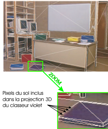
FIG. 6.4 – Problème de calage des données, occasionnant un calcul de réflectance moyenne erroné : la moyenne des intensités de pixel dans la projection du classeur violet, est perturbée par des pixels appartenant au sol marron.
